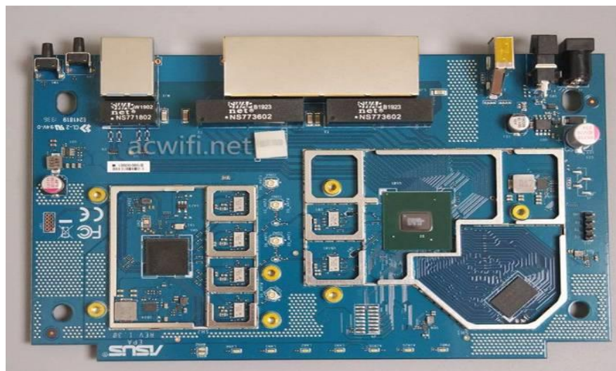
圖8、無線Wi-Fi路由器SMT製程電路板 12
