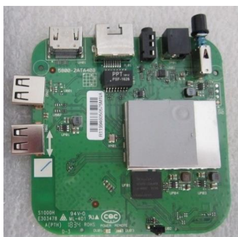
圖13、數位機上盒SMT製程電路板 17
