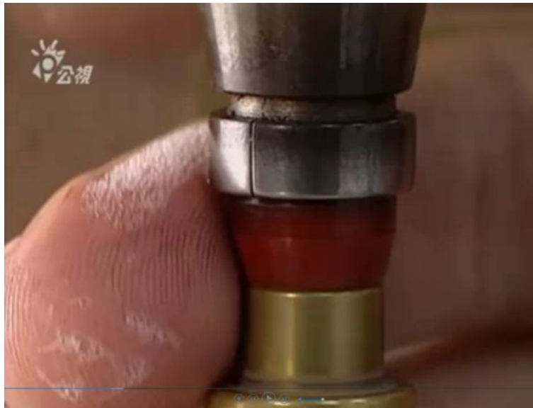
圖三十四、將蠟模降溫固化。
