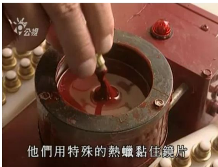
圖三十三、車削外層前必須先上蠟固定鏡片。
