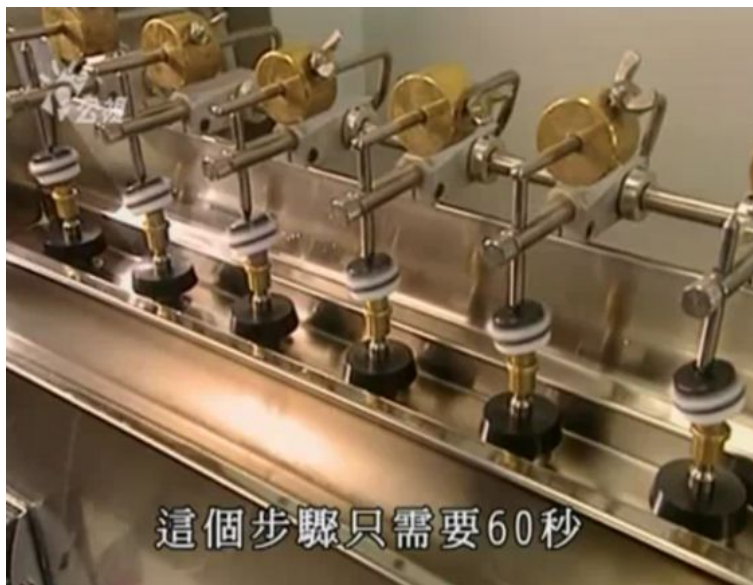
圖三十六、塗上特殊磨潤劑拋光已車削完成的鏡片外層。
