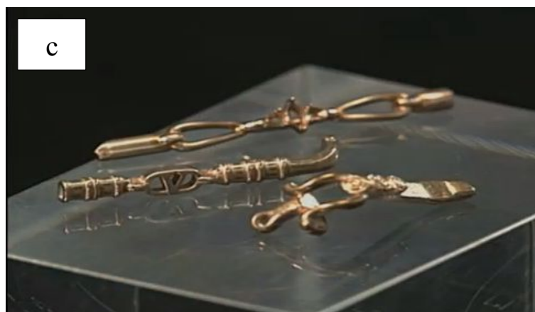
圖二十二、脫蠟鑄造製程圖:(a)製作蠟模(b)離心澆鑄(c)高溫脫蠟精鑄後得到成品件。
