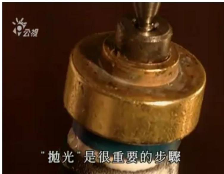
圖三十二、將車削後的鏡片內側拋光。
