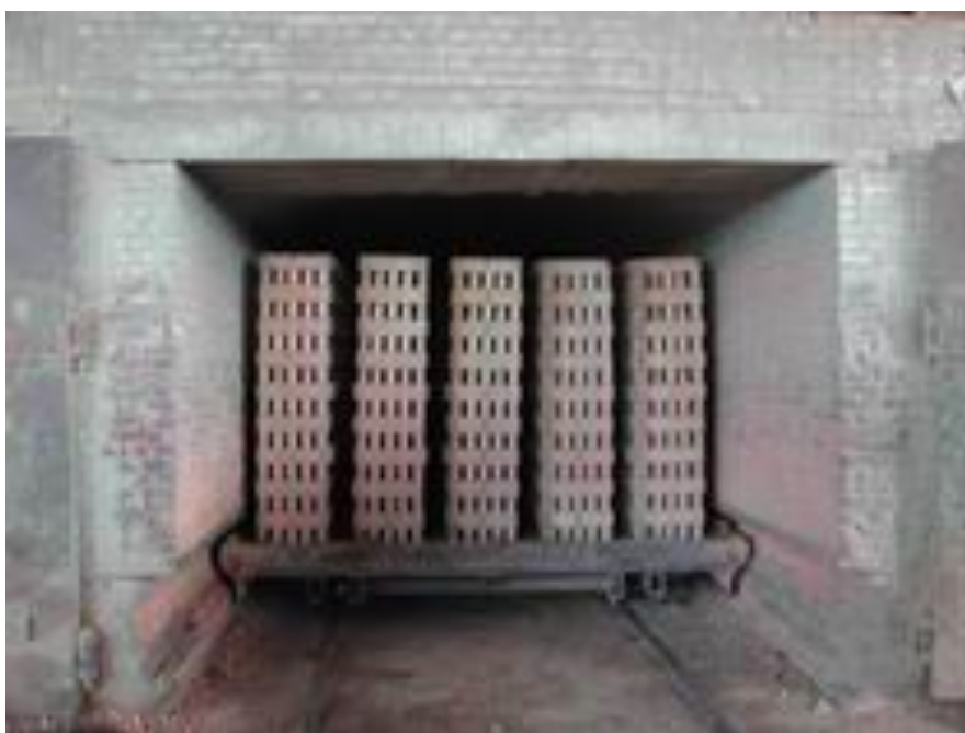
圖四、隧道窯：磚坯經烘乾後送入隧道窯燒製磚塊
