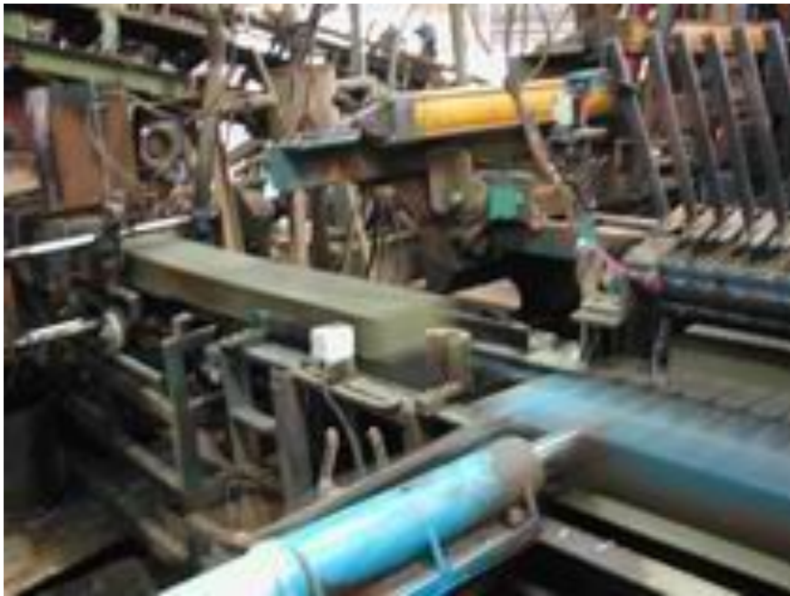
圖二、供料機、攪拌機、製磚機：將碎土機處理過之 原土，製成磚坯
