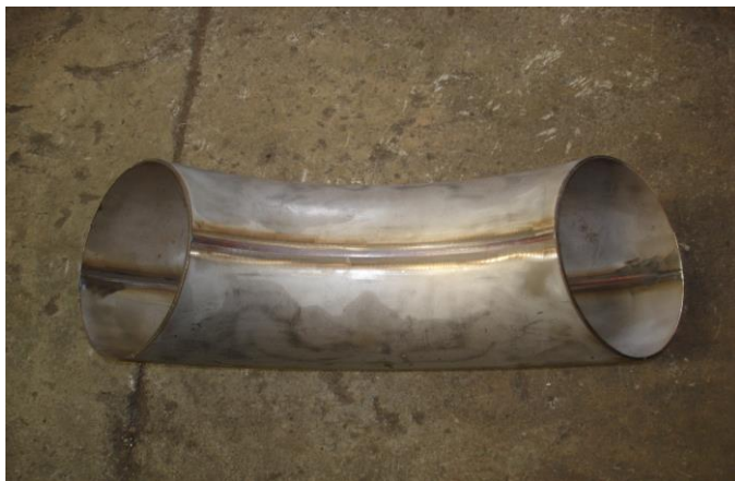
圖 30 板製雙縫彎頭成品
