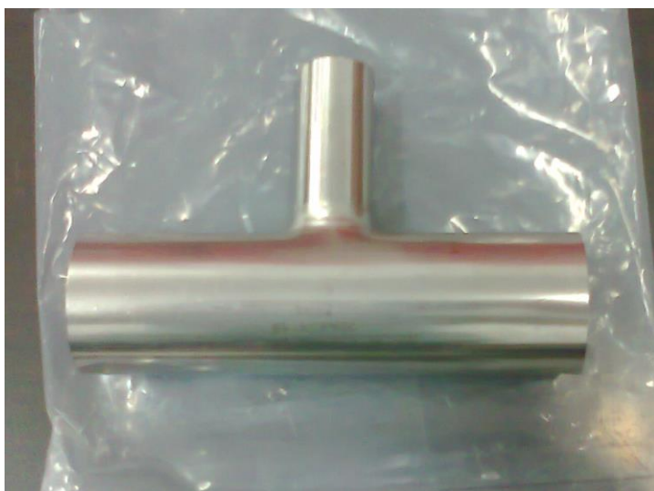
圖 33 三通(光輝退火/真空爐退火)
