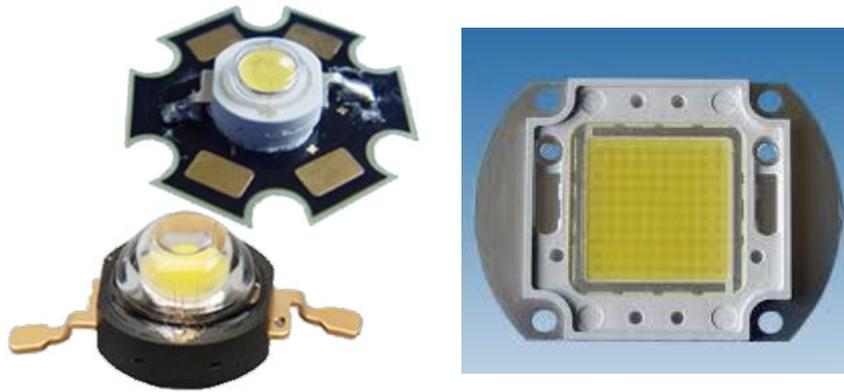
Fig. 9 幾種高功率 LED <sup>[7]</sup>
